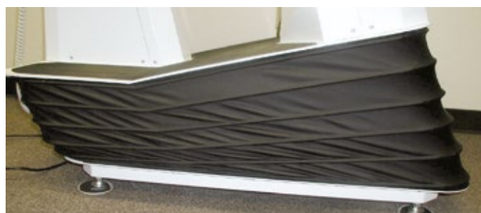
Gorframe kryt schovává funkční mechanismus naklápacího stolu odolávaje škále pohybů v různých směrech.
